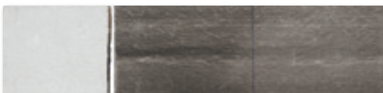
Membrană pentru acoperiș din bitum, cu un strat uniform, reflexiv din acrilat pe partea superioară
