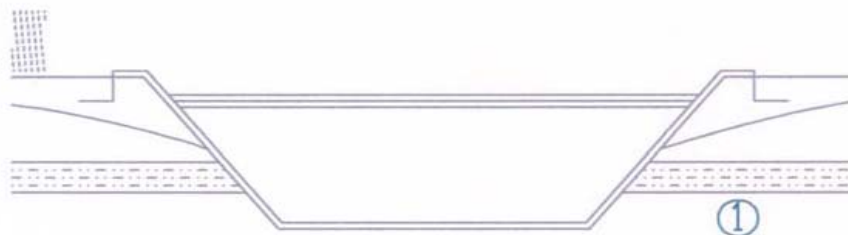
Présence d'un horizon imperméable et d'une nappe temporaire (pluie)
