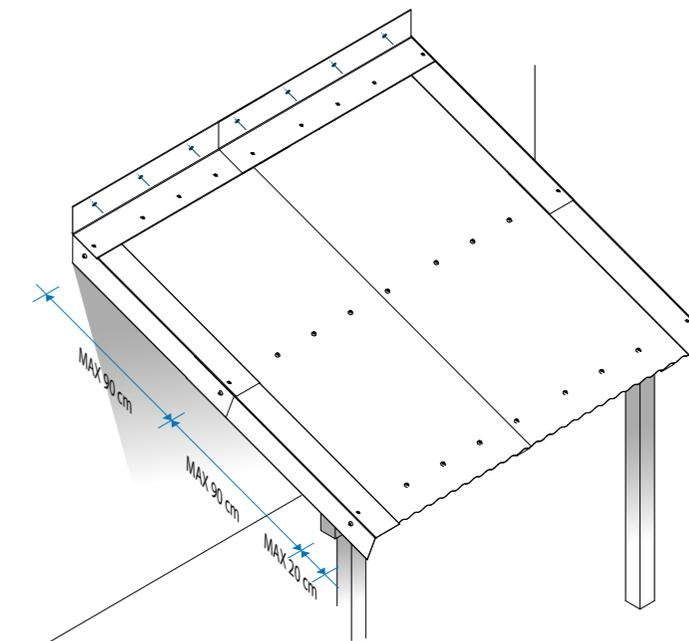
Con lo stesso procedimento si può montare la copertura di una veranda o di una pensilina addossata ad un muro. L'accessorio universale ECOTOP può essere utilizzato anche come scossalina superiore, fissandolo alla parete con viti adatte al tipo di muratura da acquistare separatamente. La sigillatura tra la parete e la scossalina può essere effettuata con una guarnizione in silicone o butile.
